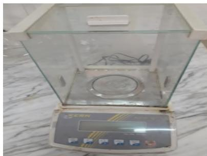
**Figure n°04:** Balance analytique
