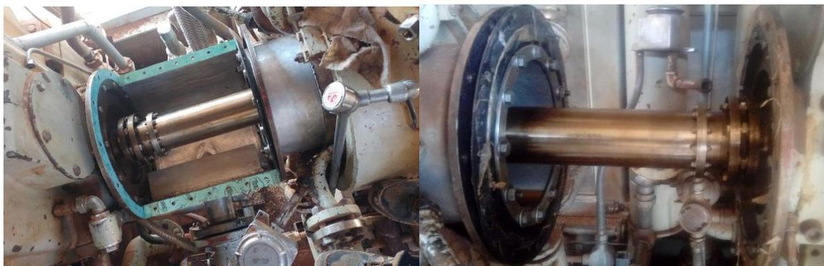
*Figure IV.5 : Enlèvement du cache d'accouplement du compresseur*
