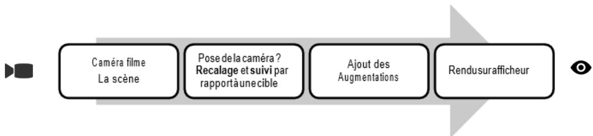
*Figure III.1 : principe de fonctionnement de la réalité augmentée.*
