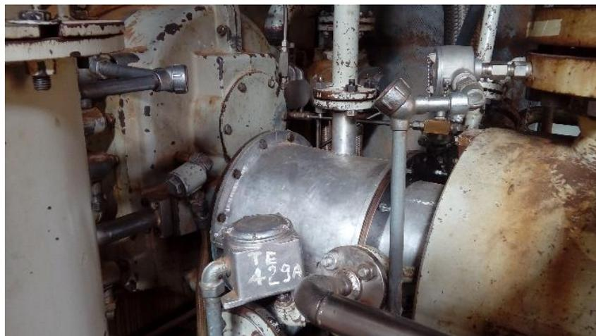
*Figure IV.4 : Desserrage des vis de fixation du cache d'accouplement du compresseur*
