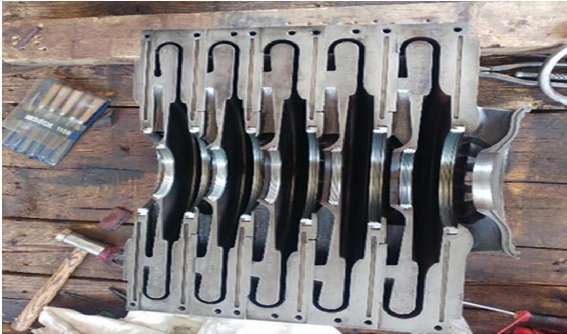
*Figure II.11 : Diaphragme du compresseur BCL K603*
