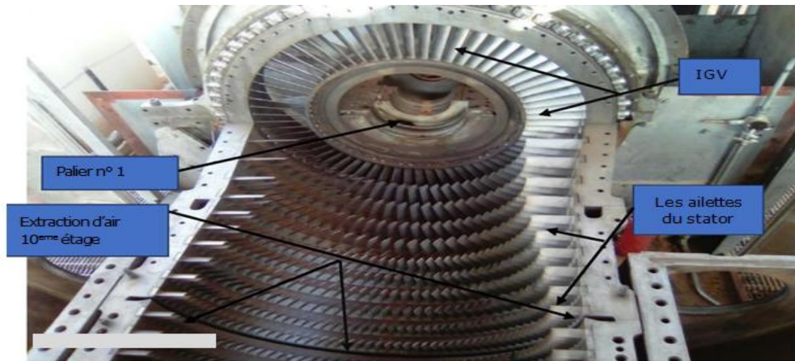
Figure II.9 : Stator du compresseur
