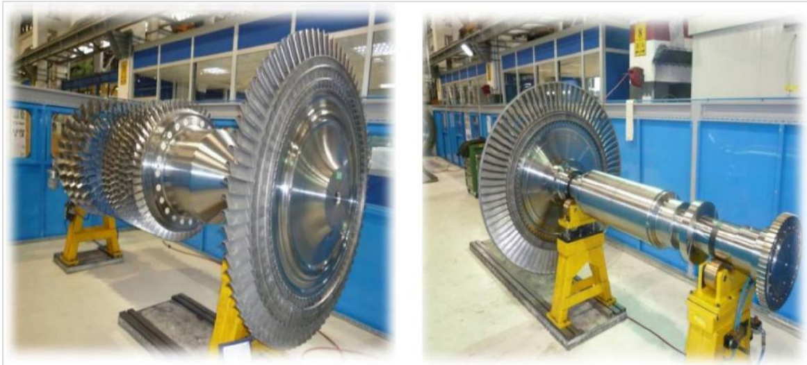
Figure II.15 : Roue de turbine HP et BP.
