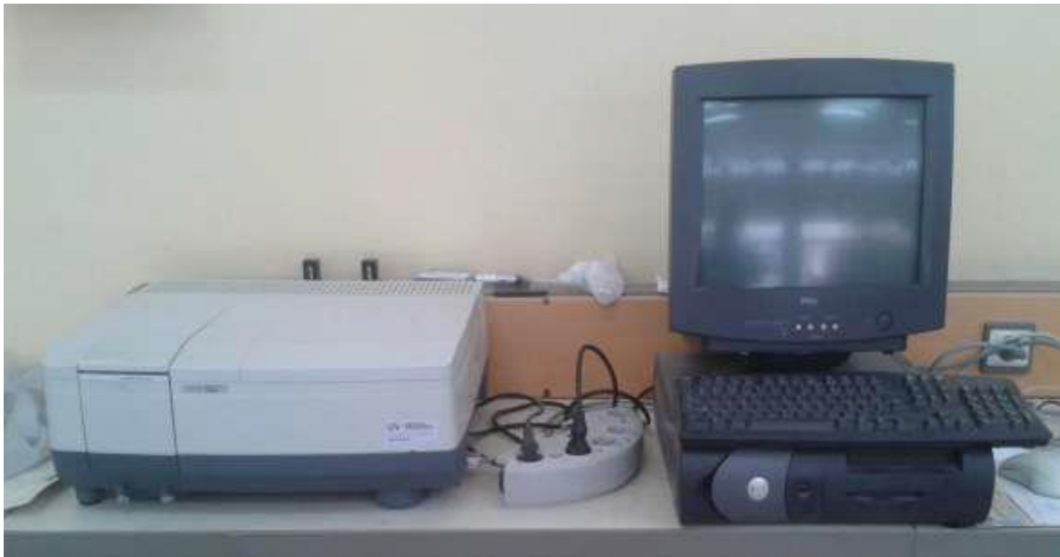
Figure III.7: Schéma de spectrophotomètre à double faisceau de type SHIMADZU (UV1650 PC).
