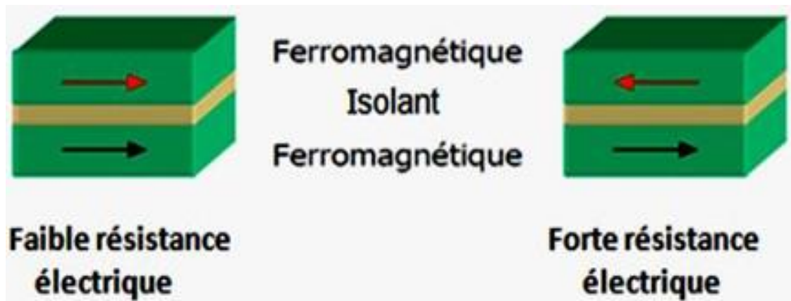
Figure I.14 : les deux états, parallèle et antiparallèle, dans une jonction tunnel magnétique.
