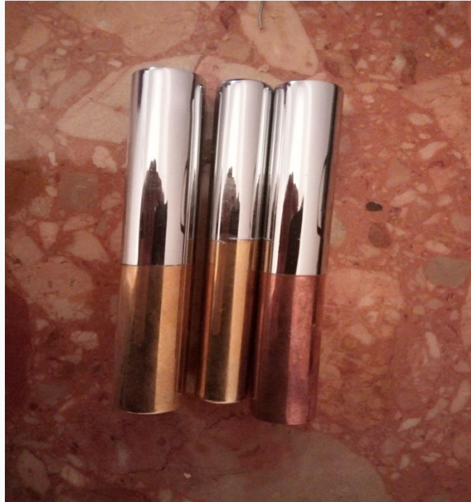
Figure III-8 : Les échantillons après le chromage.
