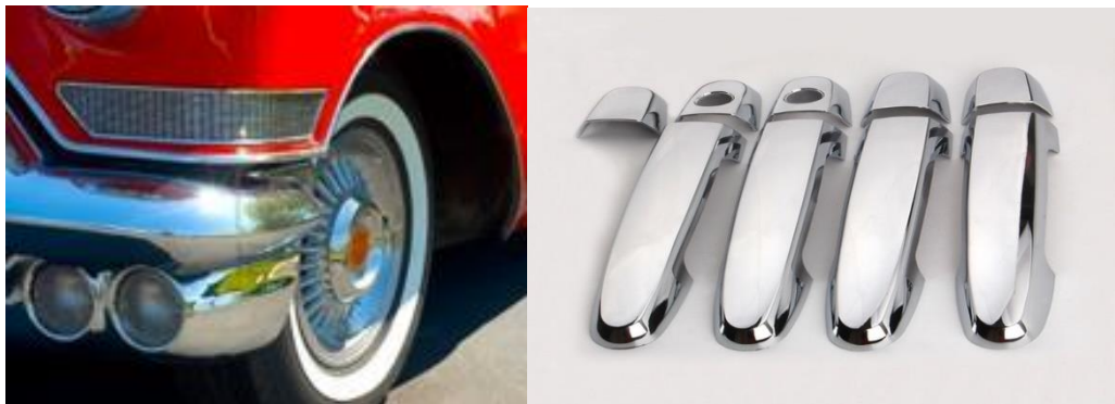
Figure II-1 : Exemple des pièces revêtues par chromage décoratif.[27,28]
