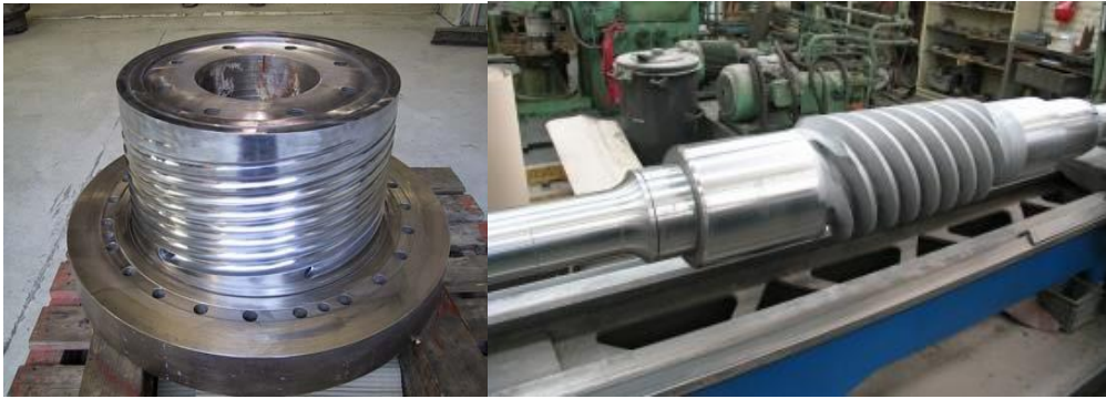
Figure II-2 : Exemple des pièces revêtues par chromage dur.[29 ,30]
