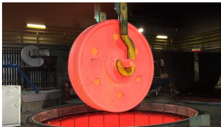
Figure I-15 : Procédé de cémentation d'une pièce métallique.[15]
