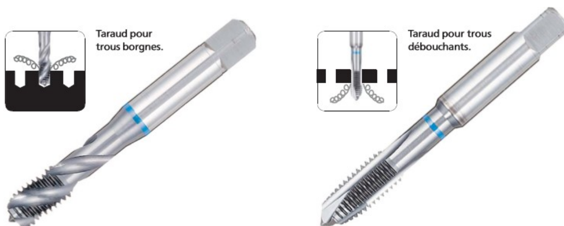
Figure II.4 : Tarauds à quatre goujures
