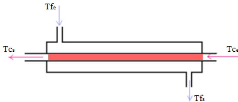
Figure I.25: Échangeur tubulaire à Contre-courant
