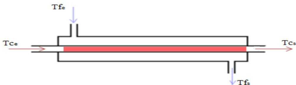
Figure I.24: Échangeur tubulaire à Co-courant
