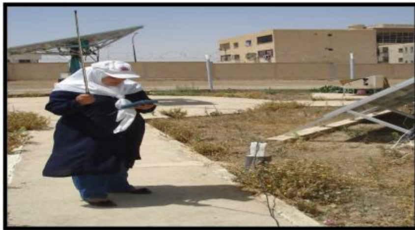
Figure 18: Mesure de la vitesse du vent à partir de AIRFLOW TA2.
