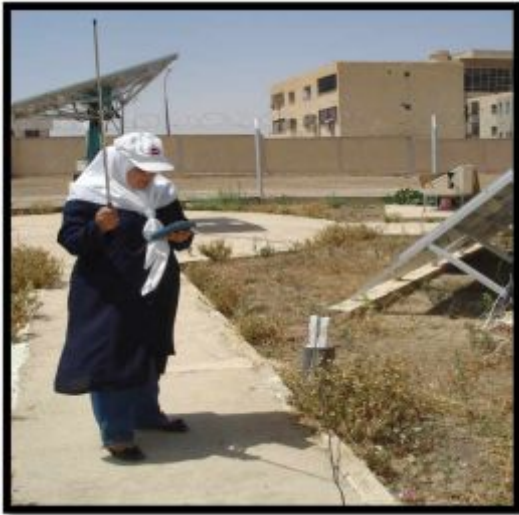
Figure 12: Mesure de la température ambiante à partir de AIRFLOW TA2.
