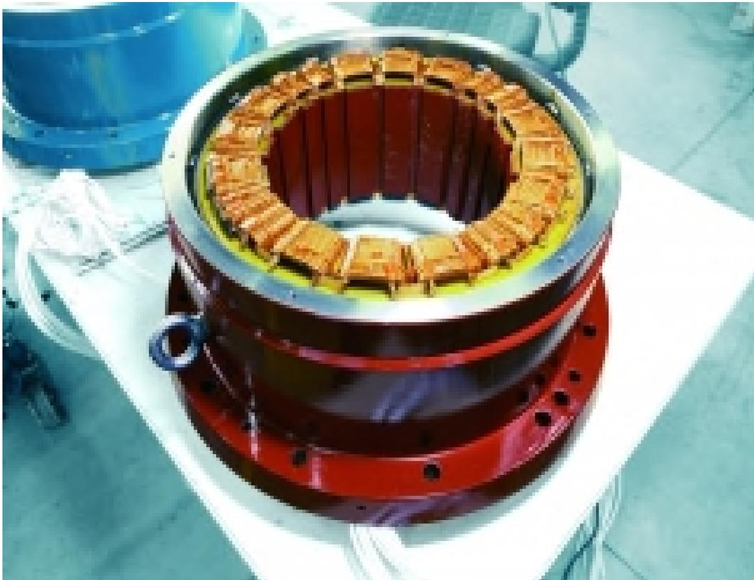
Figure I.7 : Palier magnétique
