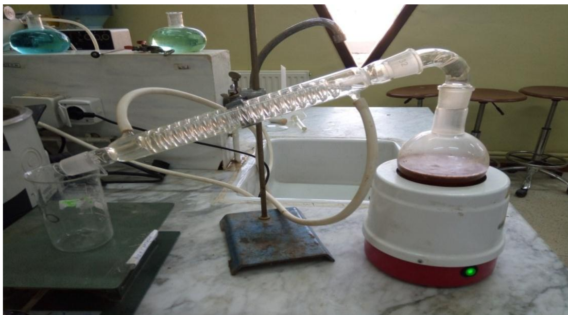
Figure 6: Montage d'hydrodistillation employé pour l'extraction d'huile essentielle
