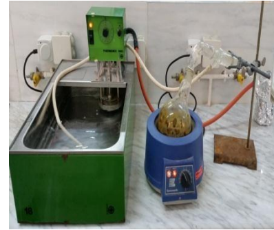
Montage pour l'Hydrodistillation
