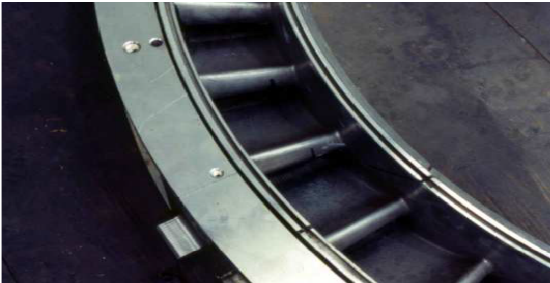
Figure I.13: schéma de directrice de premier étage
