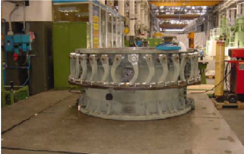
Figure I.14: schéma de directrice de deuxième étage
