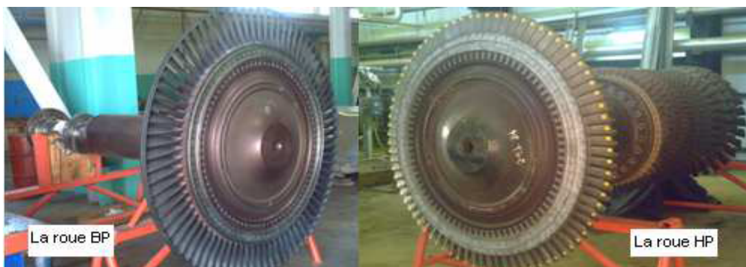
Figure I.15: Schéma de rotor HP et rotor BP
