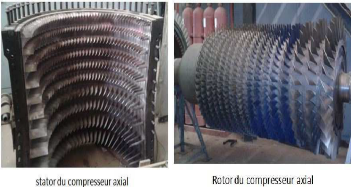
Figure I.8: Schéma de rotor et stator du Compresseur axial
