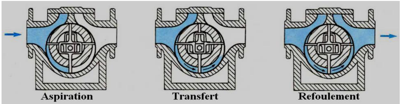
Figure I.9 : Pompes à palettes guidées. [4]
