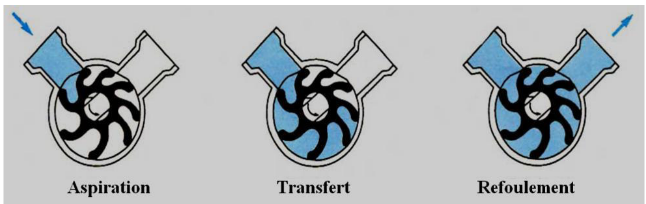
Figure (I-8) : Pompes à palettes flexibles. [4]
