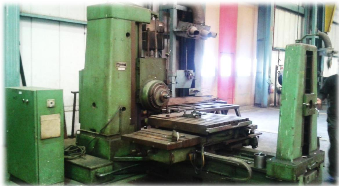
**Figure 2.1** :Fraiseuses aléuseuse.
