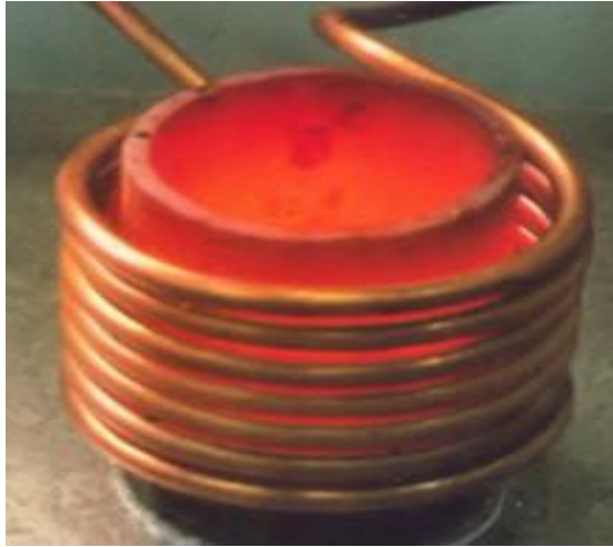
Figure 2.3.: Chauffage d'un métal par induction
