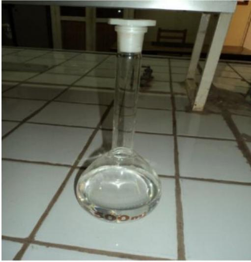
Figure 3.13: Essai au pycnomètre
