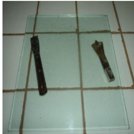
**Figure 3.9:** Appareil de Casagrande et outil à rainure.
