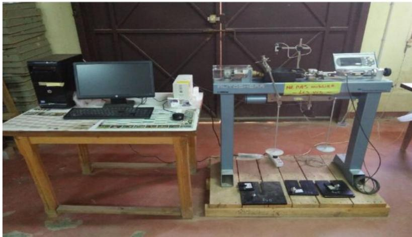
**Figure 3.20:** Boîte de cisaillement carrée de Casagrande
