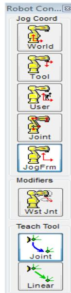
**Figure II.17.** Barre d'outils de coordonnées sur ROBOGUIDE
