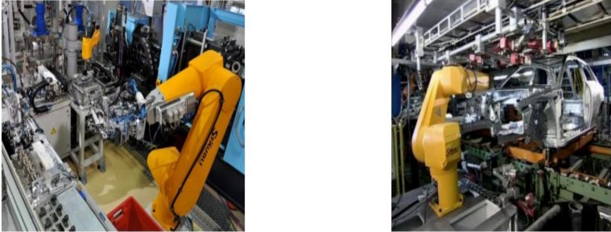
**Figure I.38** La robotique pour les applications d'assemblage.
