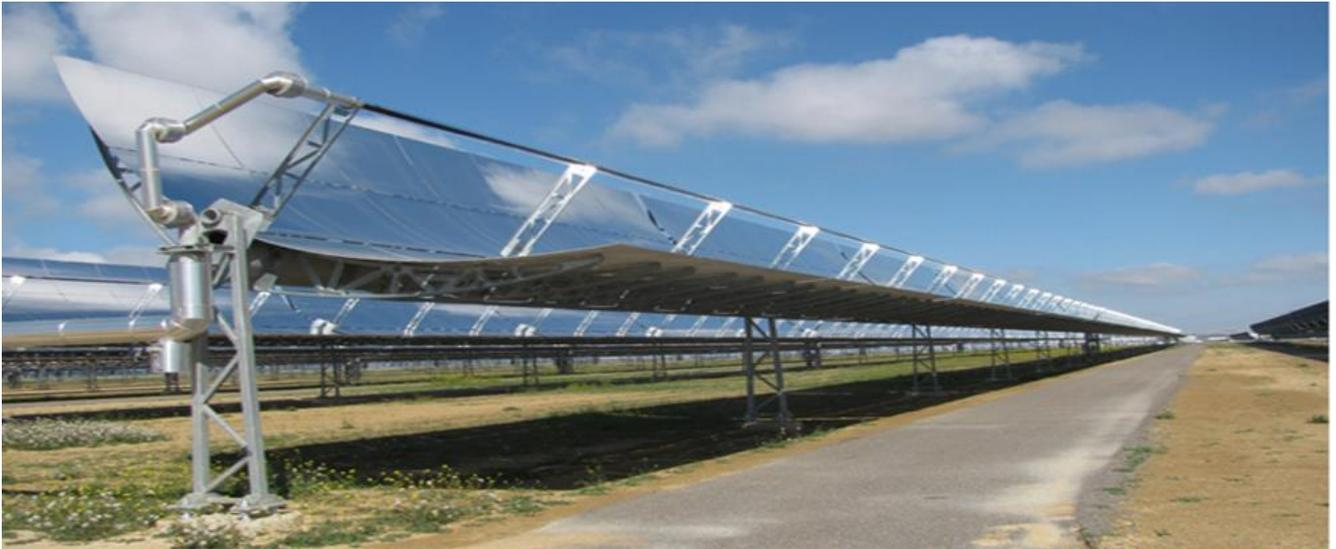
Image 8 : les capteurs cylindro-paraboliques.
