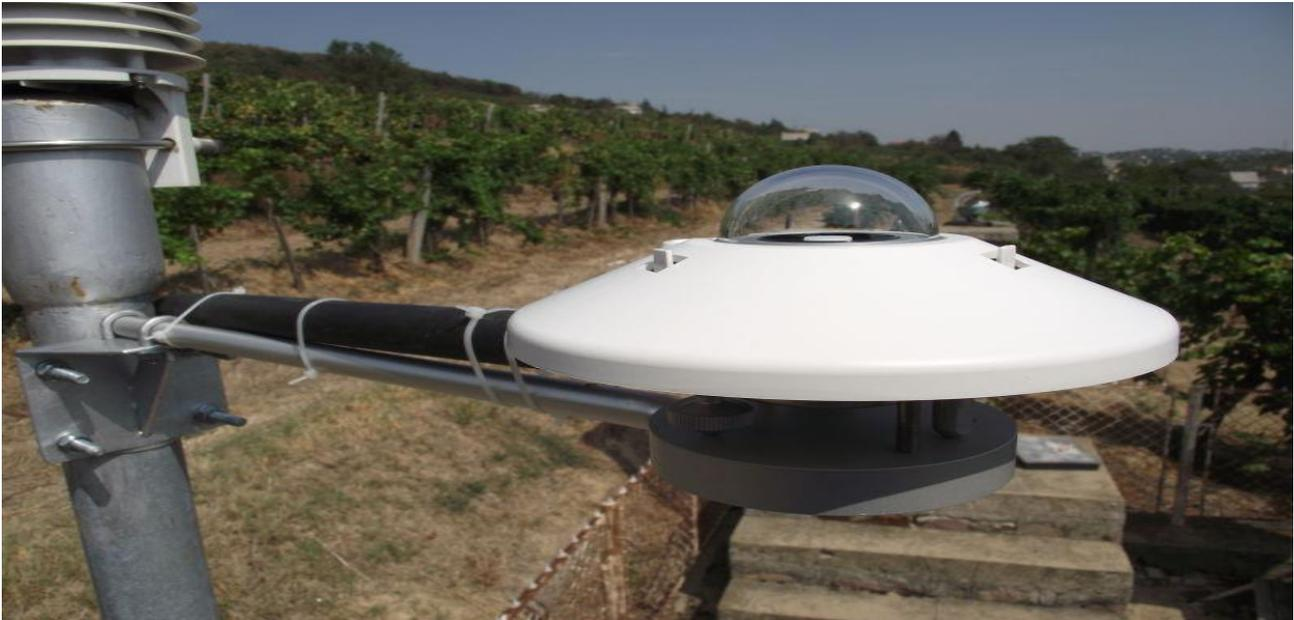
Image 14 : Pyranomètre.
