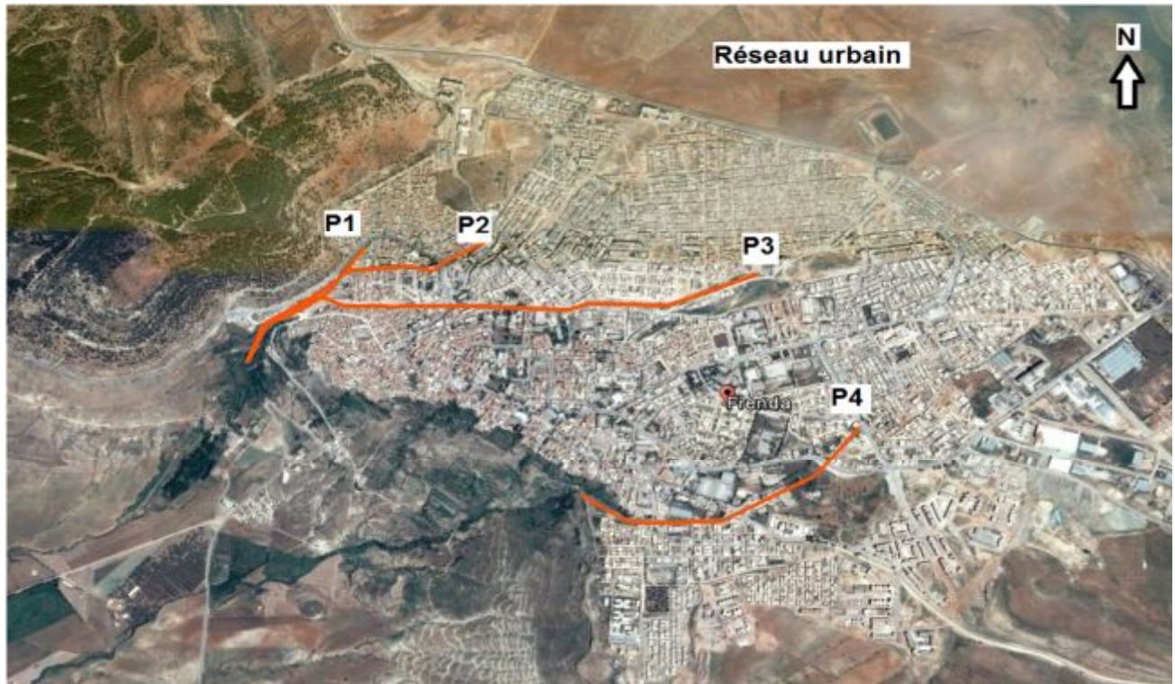
Figure 33: Réseau d'évacuateurs principaux.(tracè par google Earth)
