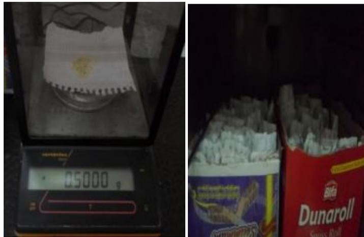
**Figure 8** : La pesée et la mise de l'échantillon dans l'étuve.
