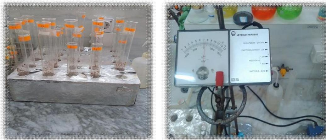
**Figure 19** : La procédure de mesure du pH des graines.
