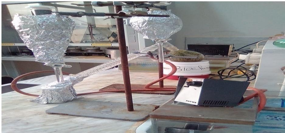
**Figure 15** : L'hydro-distillateur (appareil d'extraction des huiles essentielles).
