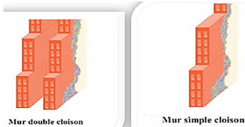
Figure I.2 : Mur simple cloison et double cloison
