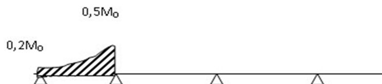
Figure .III 3 Valeurs admissibles (travée de rive).
