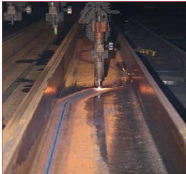
**Figure.6** : Oxycoupage d'une poutre « Angelina » [3].
