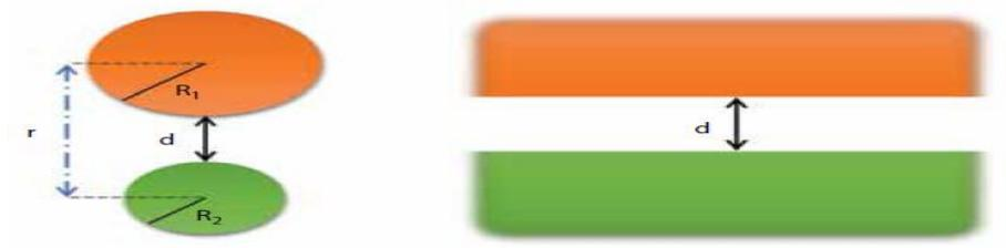
**Figure III-2 :** Interactions de Van der Waals entre deux sphères (à gauche) et entre des demi-espaces parallèles (droite) [30].
