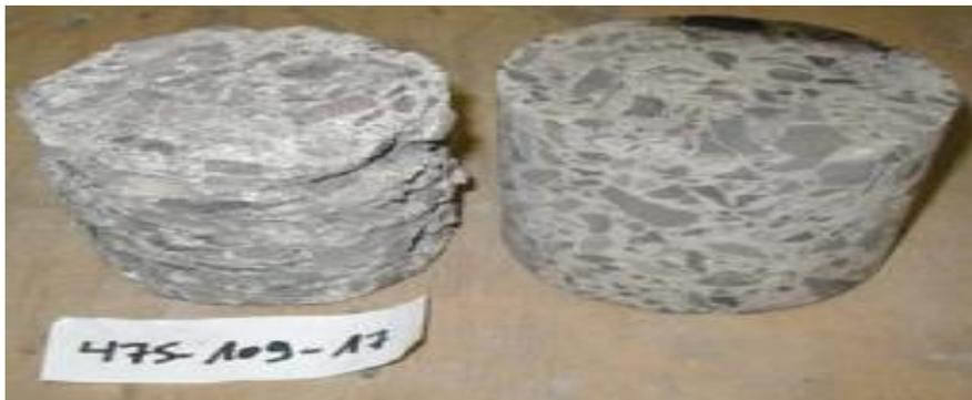
Figure I.3: Attaques acides à une carotte au béton. [(Dossiers du CSTC) ,2004]
