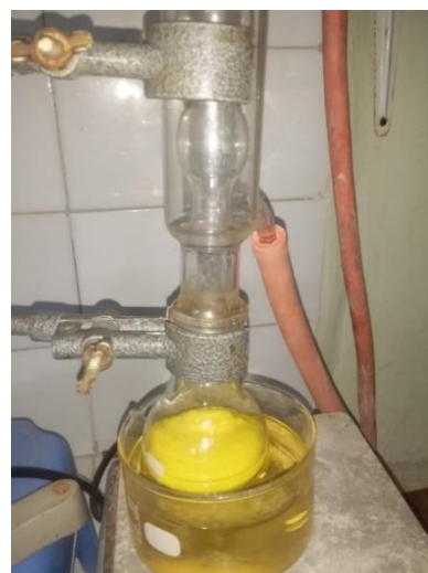
Figure II.4 : Le montage de reflux d'isatine -thiosemicarbazide
