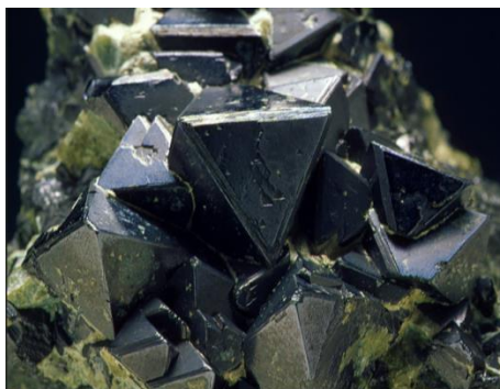
Figure I.2: magnétite. Cet échantillon montre des cristaux caractéristiques octaédriques, aux faces striées, de couleur gris fer à noir [1].
