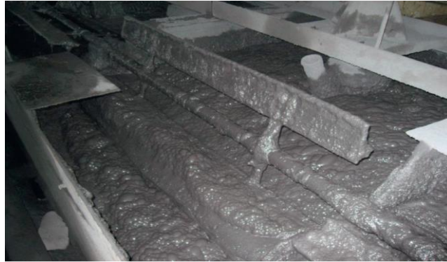
Figure I.13: Cellule de flottation dans une usine de valorisation de la province du Sichuan [6].
