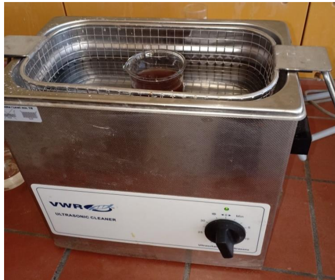
Figure III.8 : Appareil nettoyeur ultrasonique avec panier chauffant.
