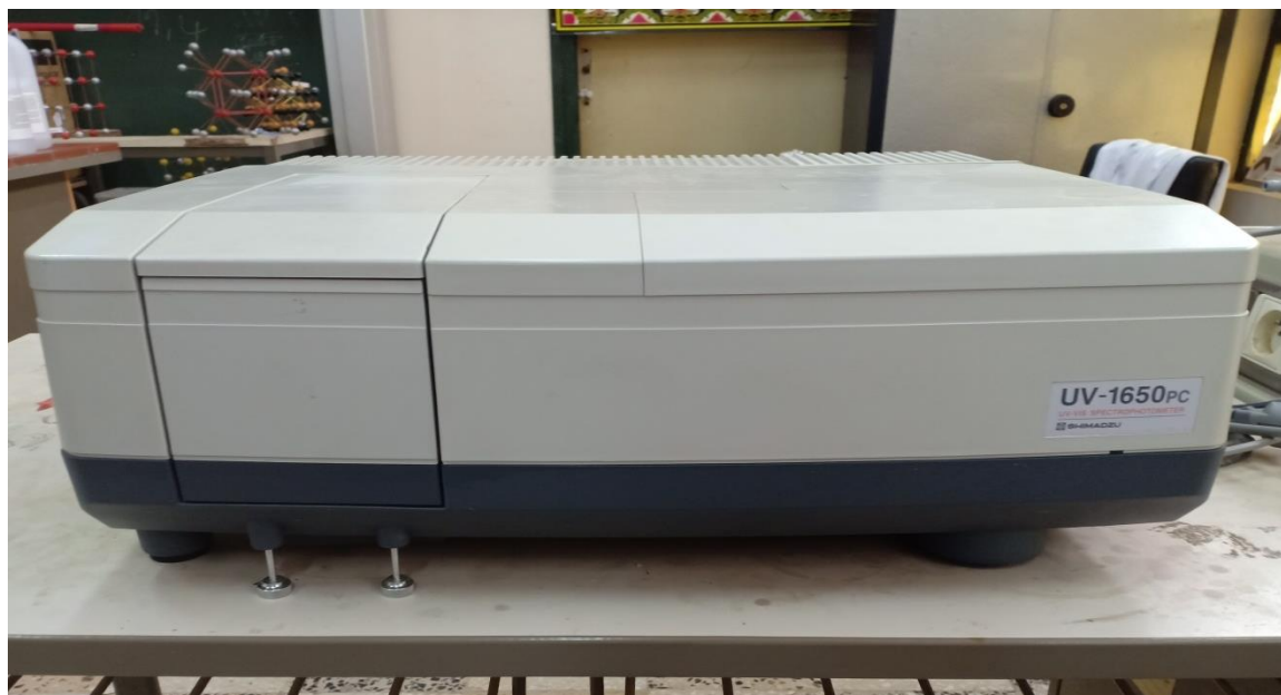
Figure III.15 : UV-Vis Spectrophotomètre SHIMADZU UV-1650 PC.
