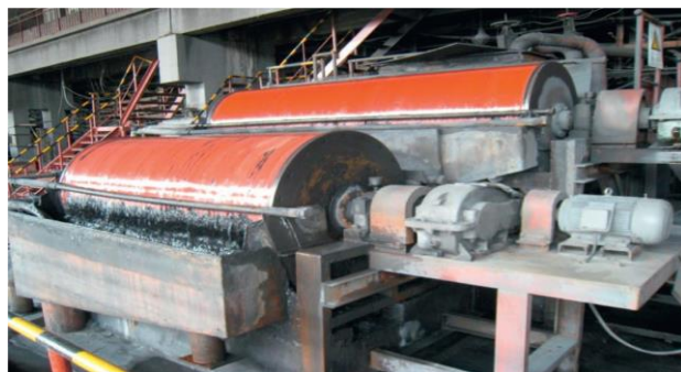
Figure I.11: Séparateurs magnétiques de faible intensité (LIMS) pour l'enrichissement du minerai [6].
