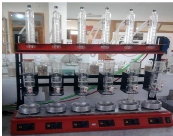
**Figure n°07:** Photographie de l'extracteur Soxhlet.
