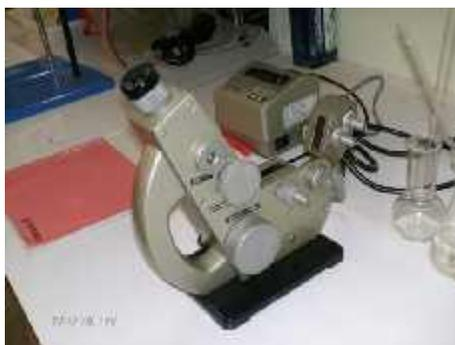
Figure n° 09 : Refractomètre (ABBE 1T/ 4T)
