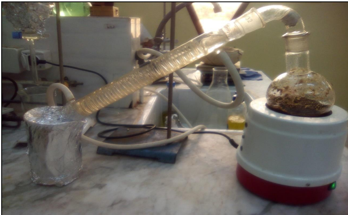
Figure 12 : Photographie du montage d'hydrodistillation employé.
