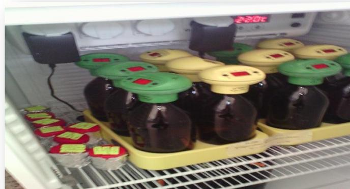
**Figure 12 :** Mesure de la DBO (Cliché Massinissa, 2018).
