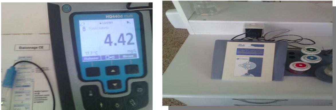
**Figure 11** : Appareil de mesure de la conductivité (Cliché Massinissa, 2018).
