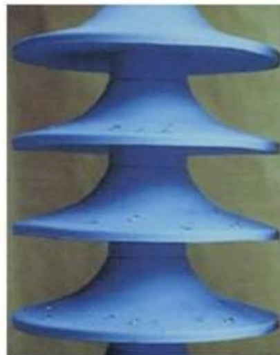
Figure I. 17 : Propriétés hydrophobes des isolateurs
