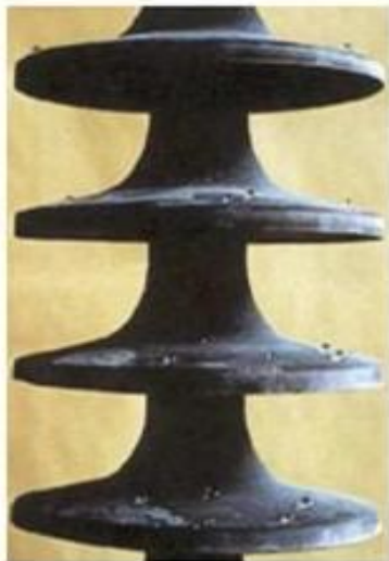
Figure I. 16 : vieillissement des isolateurs
