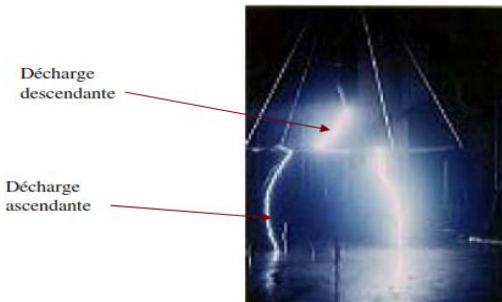
Figure III.8.Décharge disruptive dans un intervalle d'air pointe-barrière-plan de 1,5m (U près de 1100kV) [45].
