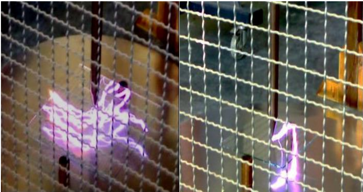
Figure III.1. Décharges glissantes sur une barrière isolante [36].
