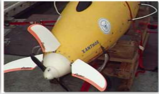
Figure 1.8 : Surfaces mobiles de l'AUV Odyssey, MIT Etats-Unis.
