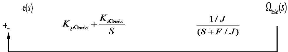
**Figure B.1** : Schéma fonctionnel de régulation de la vitesse.
