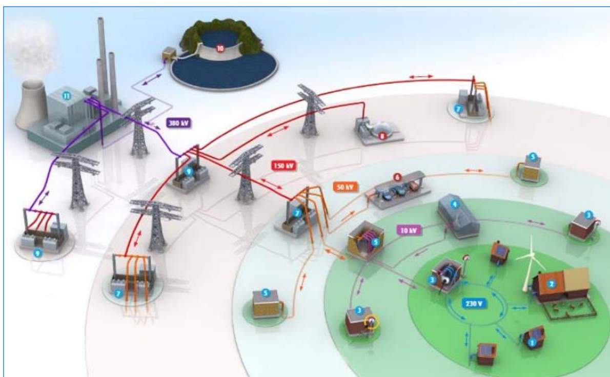
Fig. II-2 : La distribution d'énergie électrique.
