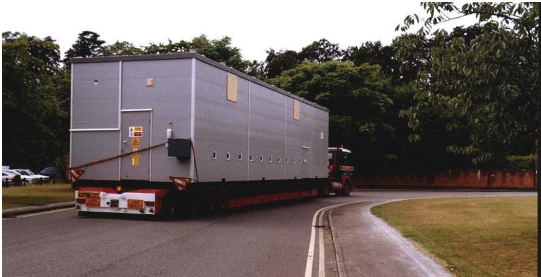
Déplacement d'une Cabine de STATCOM
