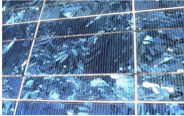
Figure (I-4) : Panneaux PV) cellule poly cristalline)
