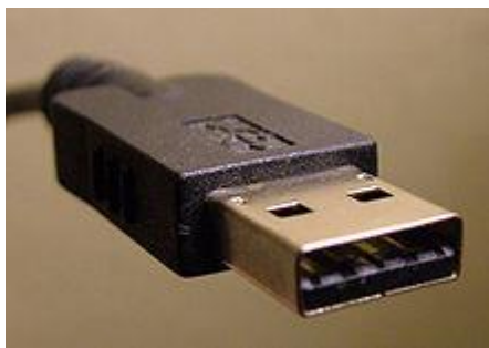
Figure 13 : Connecteur USB de type A mâle.
