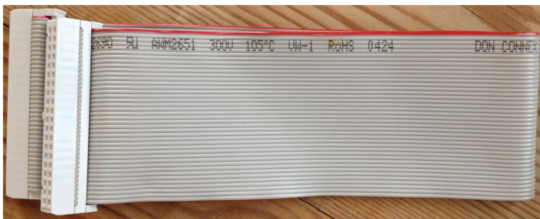
Figure 44 : un connecteur IDC 40
