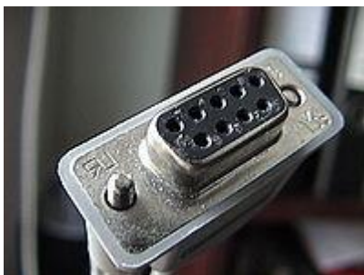
Figure 7 : Prise femelle extrémité de câble type DE-9
