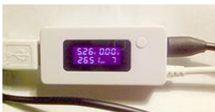
Figure 19 : Petit accessoire affichant et enregistrant la tension (V), le courant (A) et la charge (mAh) au cours de l'alimentation d'un appareil par USB, telle que la recharge d'un téléphone.
