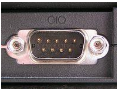
Figure 8 : Un connecteur DE-9 (Improprement appelé DB-9) mâle utilisé comme port série sur un ordinateur personnel
