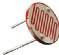
Fig. III.4: Photo d'une photorésistance (LDR)
