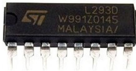
Fig. III.14: Circuit L293D
