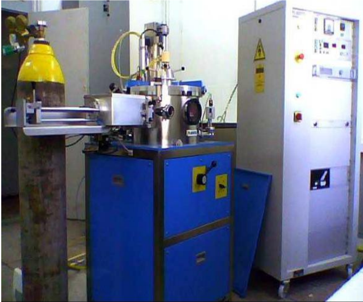
Figure II.7: appareillage de la pulvérisation cathodique RF
