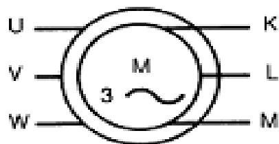
(b) Symbole du moteur asynchrone à rotor bobiné.
