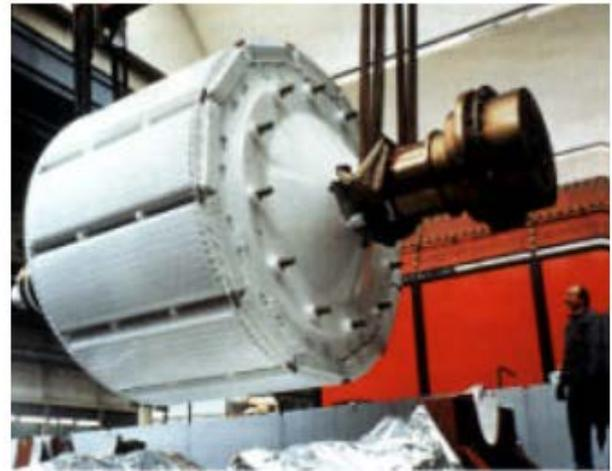
Fig. II.2: moteur industriel à aimants permanents. Fig. II. 3: rotor de moteur synchrone à pôle Saillant 100 MW (à 600 tr/mn).
