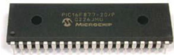
*Figure II.1: Microcontrôleur PIC 16F877A*
