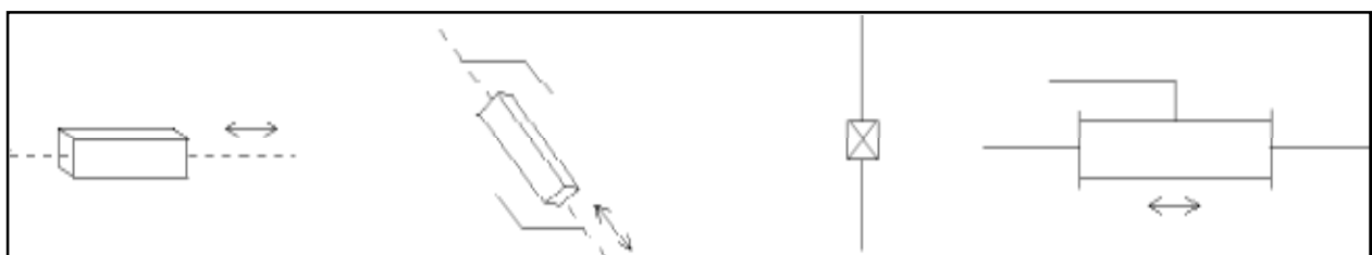
Figure 04 : représentation d'une articulation prismatique [Obeid 15]
