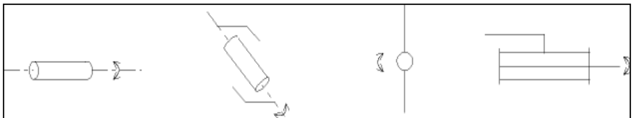
Figure 03 : représentation d'une articulation rotoïde [Obeid 15]
