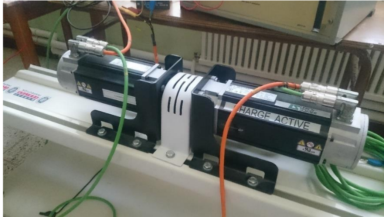
Figure IV.2 : Le moteur synchrone à aimant permanent.
