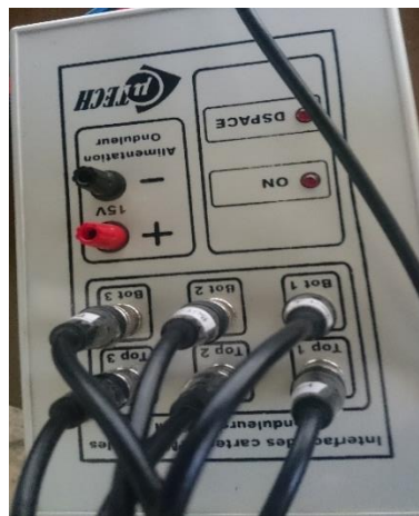
Figure IV.7 : Boîtier de conversion des signaux MLI de 0/5V vers 0/15V.
