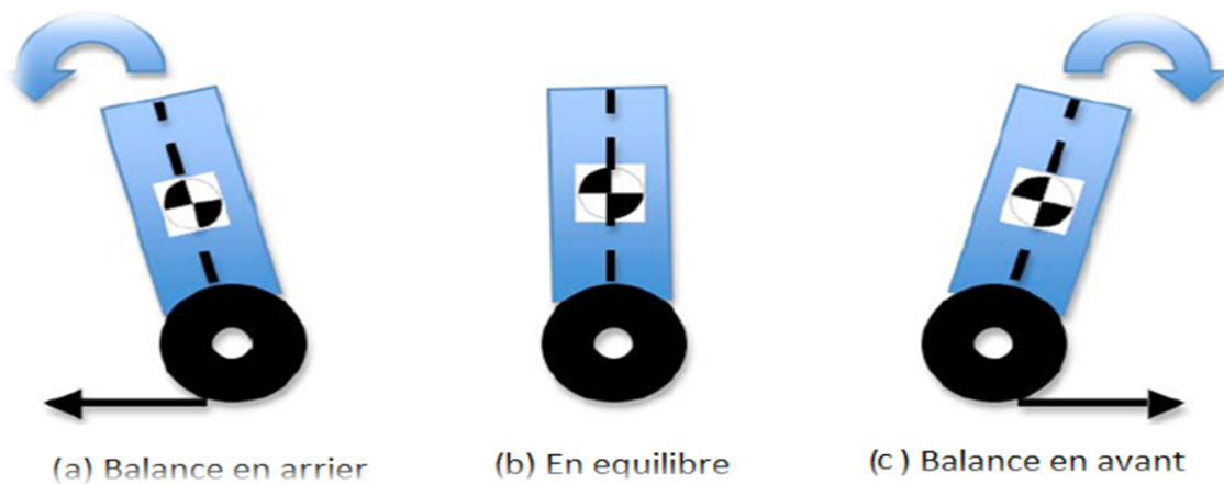
Fig I.7:Les trois cas du pendule inverse balance
