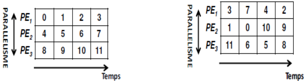
Figure II.11 : Matrice d'accès aux données pour les turbo-codes.
