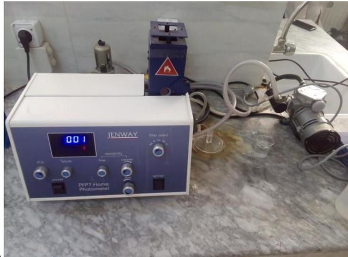
**Fig. II.4:** le Spectrophotomètre à flamme
