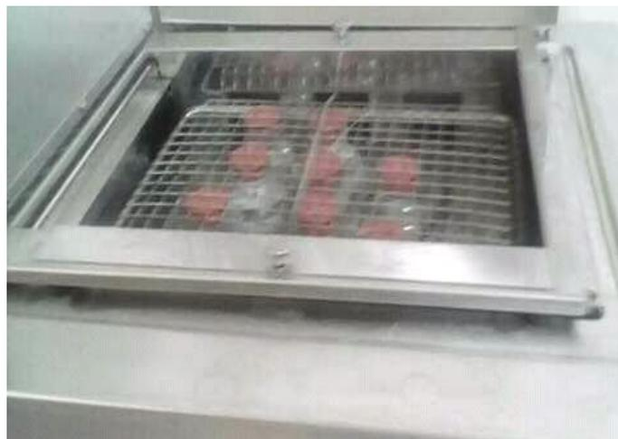
Fig. II.3 : Installation expérimentale des essais de migration.
