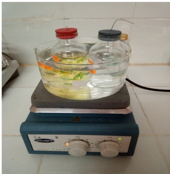
Figure II.2 : Dispositif expérimental des essais de migration.
